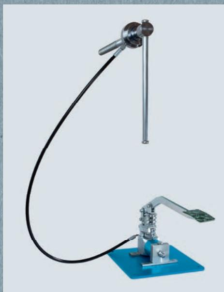
Con il modulo HEUER a corsa corta è possibile fare diventare in pochissimo tempo una morsa esistente in un vero e proprio “tenditore rapido”. Tutti i pezzi necessari per l’installazione sono forniti in set.
